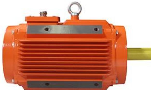
В PAD устанавливается специальный двигатель для вентиляции таких приложений, как вентиляторы и вентиляционные каналы. Безвентиляторная конструкция устанавливается внутри вентилятора или воздуховода через PAD и охлаждается воздухом, обтекающим поверхность.
